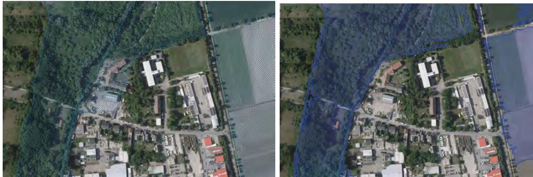
Durch Rechtsverordnung gesichertes Überschwemmungsgebiet des Floßbach (links) und Überflutungsgebiet der Isenach bei  $HQ_{\text{extrem}}$
