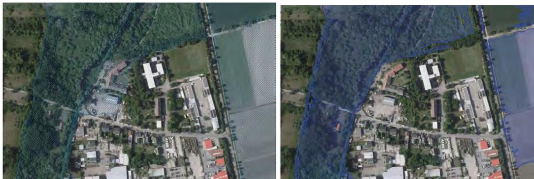
Durch Rechtsverordnung gesichertes Überschwemmungsgebiet des Floßbach (links) und Überflutungsgebiet der Isenach bei HQ<sub>extrem</sub>
