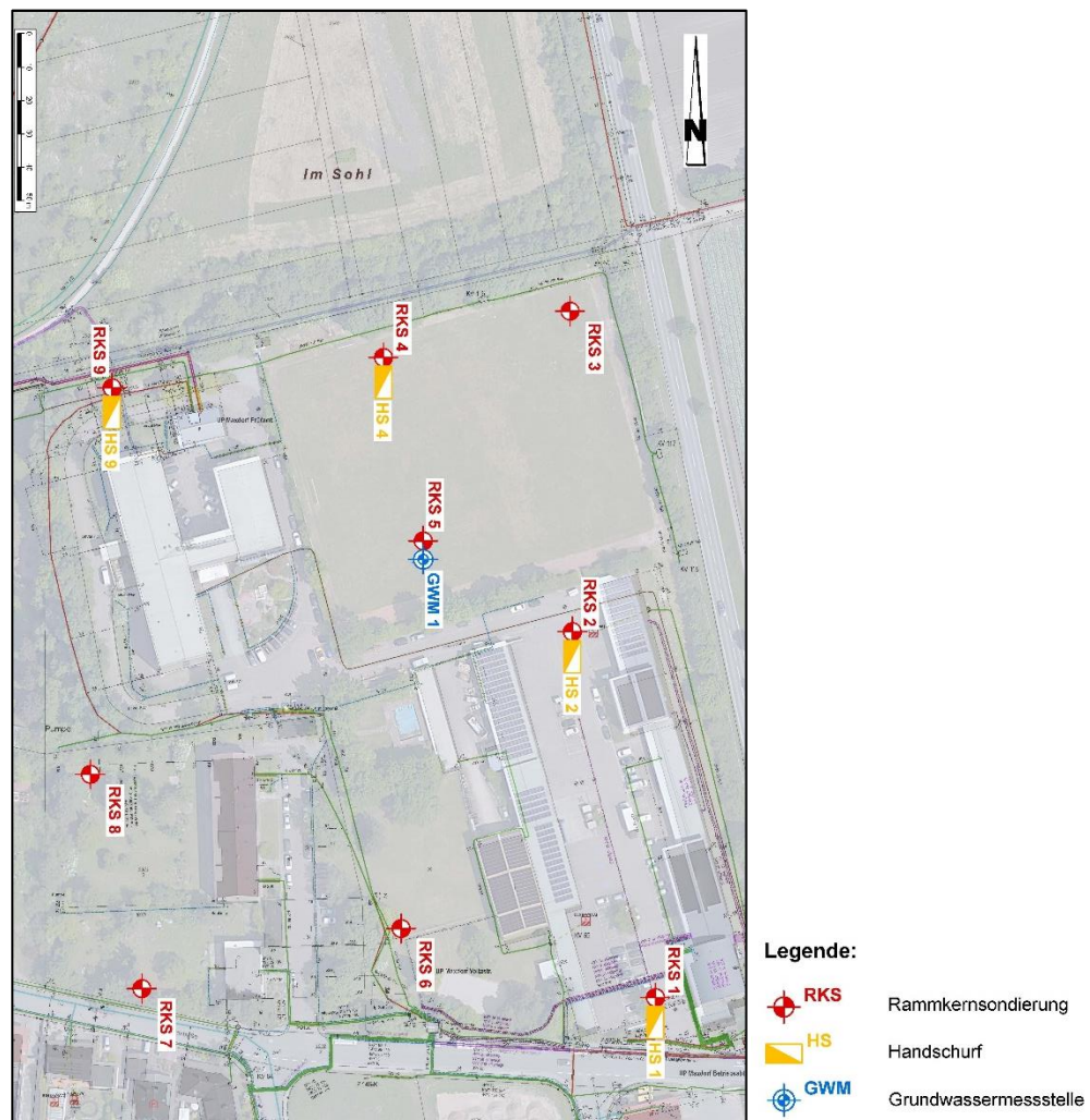
Lageplan der Untersuchungsaufschlüsse; Quelle: „Neubau Pfalzwerke Campus, Maxdorf, Baugrundvorerkundung und hydrogeologische Beratung; erstellt durch: IGB Rhein-Neckar Ingenieurgesellschaft, Ludwigshafen zum 30.11.2023; Anlage 2
